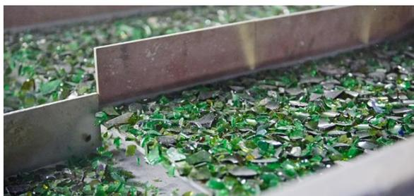
Les éléments métalliques sont retirés par tri mécanique et un tri optique permet (grâce à un rayon infrarouge) d'éliminer les éléments non transparents comme la céramique, qui n'est pas recyclable. Un souffleur retire les éléments trop légers : bouchons et étiquettes
